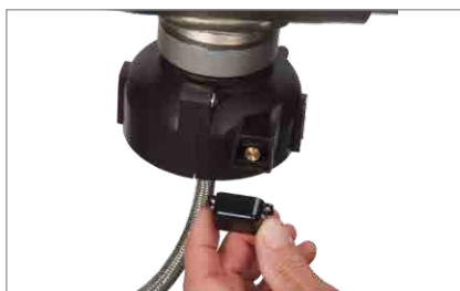
4. Retire la cubierta antipolvo del sensor.
