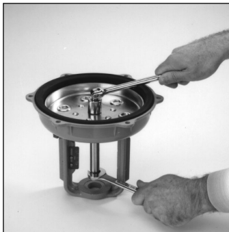
Fig 3 - Remove Stem Nut...
